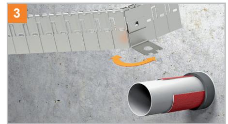
Das Metallband durch abzählen der notwendigen Metallbandglieder gemäß Tabelle mit Hilfe eines Befestigungshakens abknicken. Den Haken dabei in das Metallband oben einhängen und darauf achten, dass der Haken auf der linken Seite mit dem Metallband bündig abschließt. Metallband durch hin und her bewegen abbrennen, somit ist kein weiteres Werkzeug notwendig.
