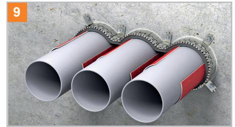
Sonderanwendung: Mehrfachdurchführung von bis zu 3 nebeneinander liegenden Rohren (PVC, PE und PP) mit einem Rohraußendurchmesser von  $\leq 75$  mm. Der Abstand von Rohr zu Rohr darf dabei max. 15 mm betragen.
