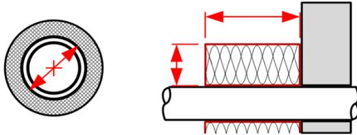
Il s'agit des dimensions minimales et maximales autorisées. Les informations détaillées concernant le domaine d'application des tuyaux en plastique et des isolations de tuyauteries se trouvent dans les attestations d'essai.
