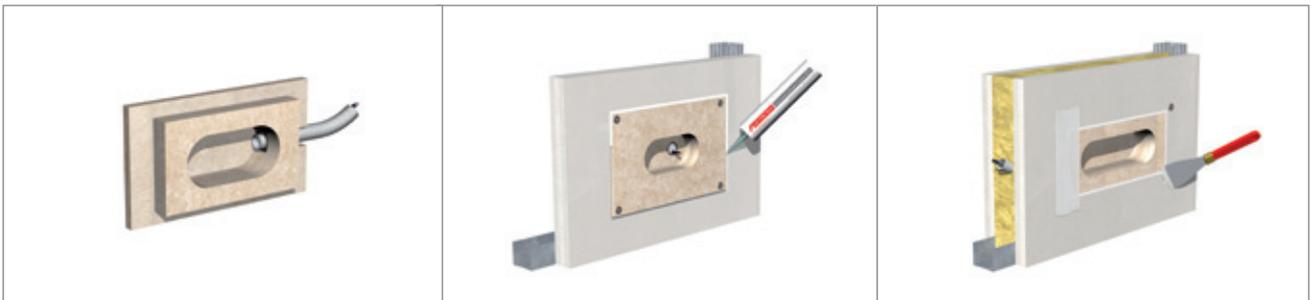
EI30 und EI90 klassifiziert gemäss EN 13501-2 für den Einbau in Gipskarton-Schachtwänden, -Ständerwänden und -Unterdeckenkonstruktionen.
