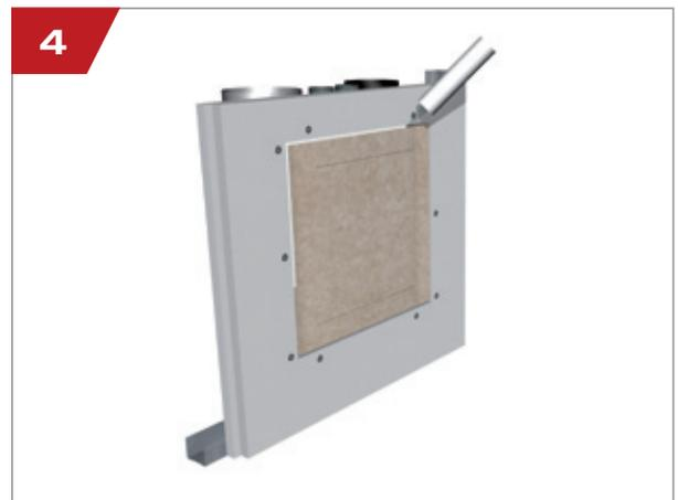
Ringspalt mit Brandschutzfugenmasse oder mit Fugenfüller ausfüllen
