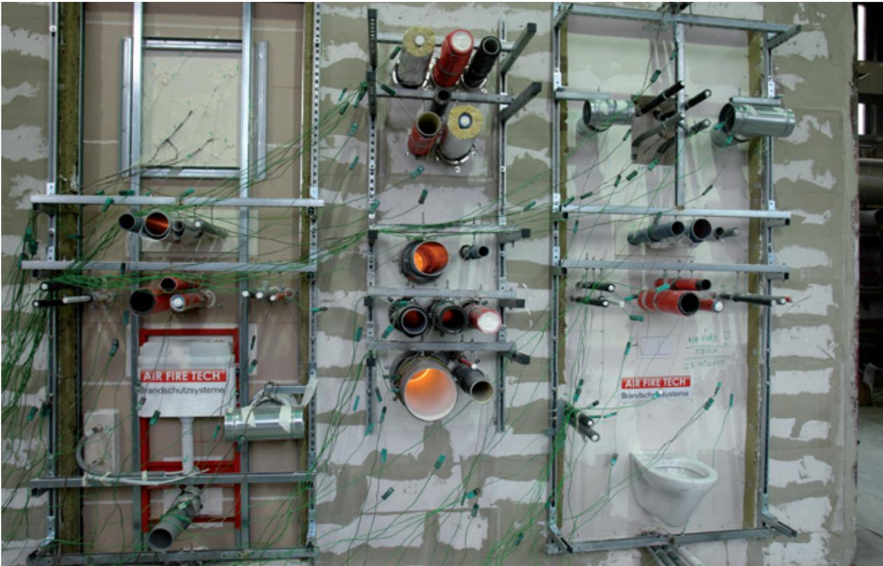
Feuerwiderstandsprüfung nach europäischen Normen inkl. WC-Unterspülkasten eingebaut in eine Schachtwand
