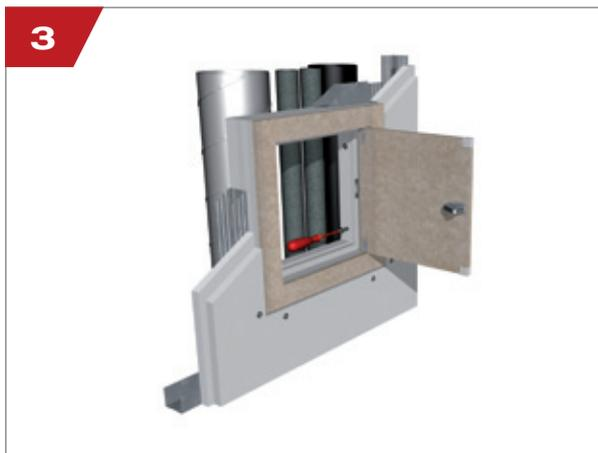
Einbaurahmen an den Montageprofilen befestigen
