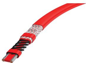
nVent RAYCHEM XTV Selbstregelnde Begleitheizungskabel werden hauptsächlich für den Frostschutz und die Aufrechterhaltung der Prozesstemperatur von Rohren/Behältern bis zu 121 °C benutzt, die eine Dampfreinigung erfordern. Sie halten einem kurzzeitigen Einsatz bei 250 °C stand. Der Fluorpolymer-Außenmantel (-CT) bietet eine hohe chemische Beständigkeit gegenüber aggressiven organischen und korrosiven Substanzen.
