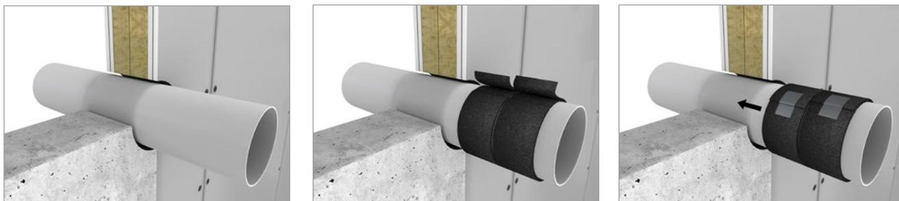
Bei Wanddurchführungen erfolgt der Verschluss des Ringspalts beidseitig mit **HENSOMASTIK® 5 KS SP** in **mindestens 5 cm Tiefe**, wie abgebildet, alternativ mit Gipsmörtel oder Mörtel (A1).
