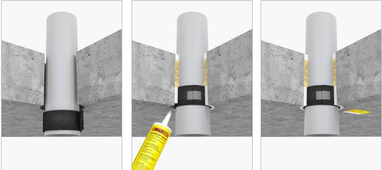
Bei Deckendurchführungen von brennbaren Rohren wird der Ringspalt zusätzlich bis zur Oberseite der Decke mit Stopfwohle (Steinwoll-dämmung) gefüllt und mit **HENSOMASTIK® 5 KS SP** verschlossen, **deckenunterseitig** in **mindestens 5 cm Tiefe**. Alternativ kann der Ringspalt mit **Gipsmörtel oder Mörtel (A1)** in der gesamten Deckenstärke verfüllt werden.
