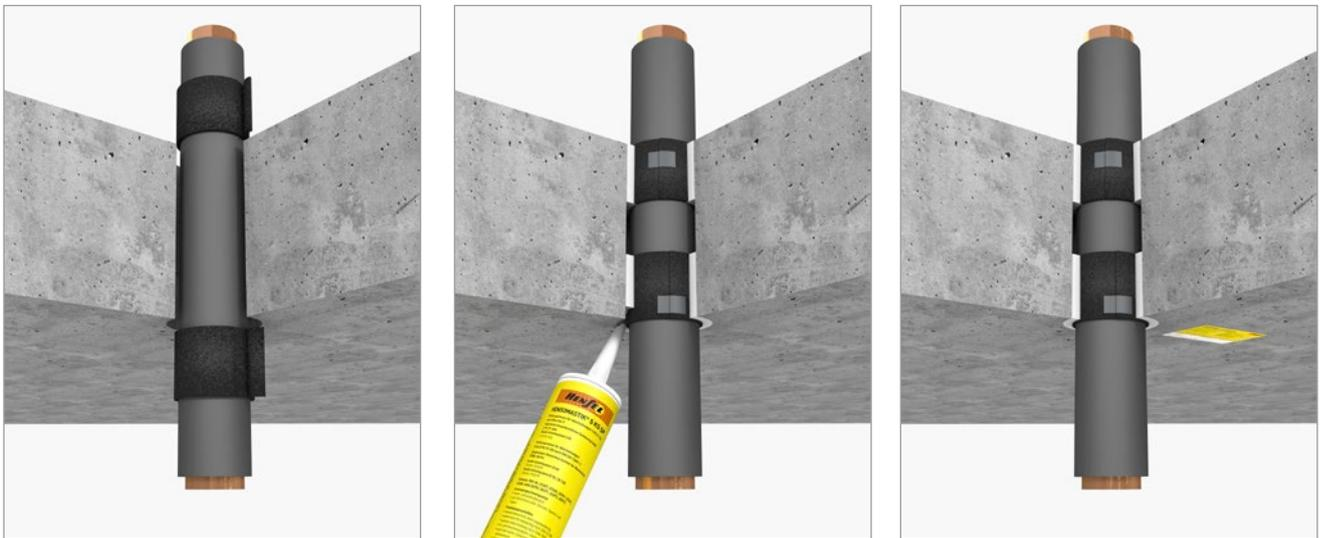
L'interstice annulaire peut également être rempli de **mortier de plâtre ou de mortier (A1)** sur toute l'épaisseur du plancher.
