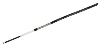
Selbstregelnde nVent RAYCHEM ETL-Begleitheizungsbander bieten einen energieeffizienten Frostschutz an Rohrleitungen. R-ETL-A/B eignen sich für Auf- oder In-Rohr-Anwendungen, R-ETL(-A/B)-CR nur für Auf-Rohr-Anwendungen. Gibt es jeweils in zwei Ausgangsleistungen (10 und 16 W/m bei 5 °C) und wird durch eine breite Palette von Warmschrumpfanschlüssen und Zubehör unterstützt.
