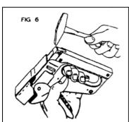
**TACKER WARTEN:** Sollte der Tackerkopf durch eine evtl. zerdrückte Klammer oder Klammerstau verstopft sein, Tackerkopf vorsichtig öffnen, wie im Abschnitt "ENTLADEN" beschrieben, und Klammerstau entfernen (FIG. 5), Tackerkopf bei Bedarf vorher mit leichten Hammerschlägen lockern (FIG. 6).
