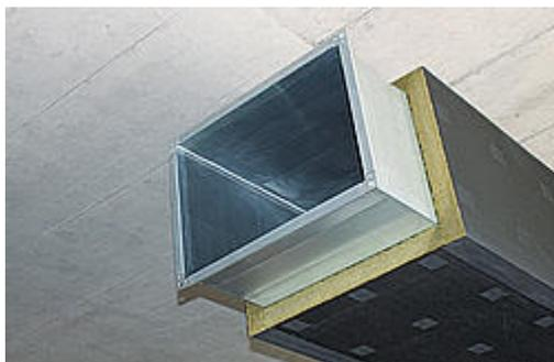
Revêtement anti-feu monocouche EI 30 pour conduits de ventilation en acier galvanisé. Certifié selon la norme la plus récente EN 1366-1:2014, y compris montage traversant pour parois de séparation légères.
