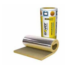
ISOVER VENTILAM Alu Plus est un matelas de laine de verre résistant à la pression, composé de lamelles verticales, recouvertes d'un côté d'un film en aluminium pur renforcé et de l'autre côté d'une couche autocollante avec un film de séparation.
