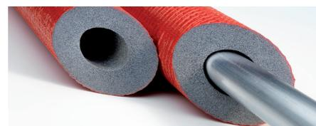
Tube isolant en mousse polyéthylène à cellules fermées à base de NMC Naturefoam® lequel contient au moins 50% de matières premières renouvelables, avec une membrane extérieure de protection pour des applications dans le domaine des installations de chauffage et de sanitaire. CLIMAFLEX® STABIL 04 mm aussi bien disponible avec membrane de protection rouge que bleu.
