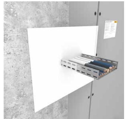
Entfernen Sie das Klebeband. Eine farbige Gestaltung kann mit **HENSOTOP SB** oder **HENSOTOP WB** in 50-100 µm Trockenschichtdicke erfolgen.
