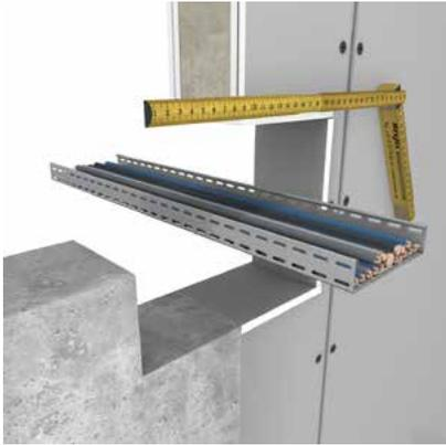
Messen Sie Länge und Breite der Öffnung und der durchgeführten Versorgungsleitungen und übertragen Sie die Maße auf die Mineralfaserplatten.
