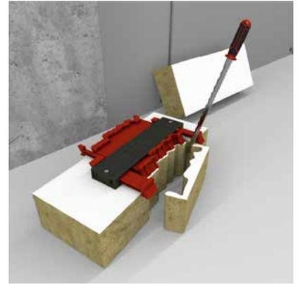
Schneiden Sie die gebrauchsfertige, beidseitig beschichtete Mineralfaserplatte in passgenaue Stücke, um sie genau in die Öffnung einzupassen.
