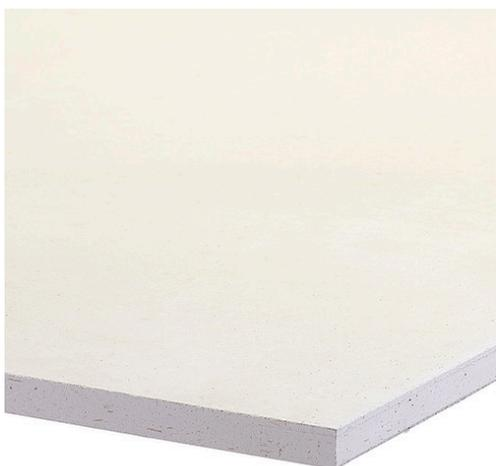
La languette Glasroc F est coupé d'une plaque de fibro-plâtre destinée au parachèvement intérieur. La plaque est incombustible, renforcée par une double membrane en fibres de verre, placée directement sous la surface de l'âme de plâtre est a des bords francs et sans carton, suivant NBN EN 15283-1:2009.
