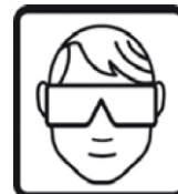
Bei Überkopfarbeiten Schutzbrille tragen.
