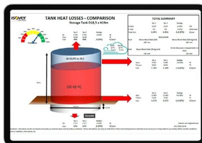
Cet outil d'isolation des réservoirs détermine la déperdition de chaleur en fonction du type de fluide, de leur degré de remplissage et de leur système d'isolation.
