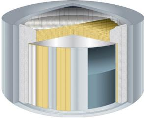
Les exigences fixées pour les réservoirs de stockage cryogéniques, par exemple pour le gaz naturel liquéfié (GNL), l'oxygène liquide ou l'azote, sont très strictes tant pour la construction que pour le système d'isolation. La capacité du réservoir peut se dilater et se contracter en fonction du niveau et de la température du liquide. L'isolant doit donc être flexible et compressible.
