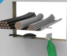
Sorgen Sie dafür, dass die Durchführungen und der Durchbruch frei von Staub, Schmutz und Fett sind. Falls erforderlich, befeuchten Sie die Konstruktion.
