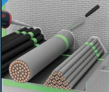
Füllen Sie dann Fugen und Öffnungen rund um die Durchführungen und Konstruktion mit Multimastic-SP auf und streichen Sie die Fuge mit einem feuchten Schaber oder Spachtel glatt.
