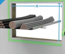
Messen Sie dann den Durchbruch und die Durchführungen, und zeichnen sie diese auf der Multimastic FB Brandschutzplatte an.
