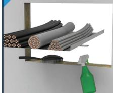
Veillez à ce que les pénétrations et l'embrasure soient exemptes de poussière, de saleté et de graisse. Humidifiez la construction si nécessaire.
