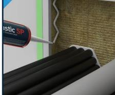
Coller le pare-feu en laine de roche Multimastic FB avec la pâte de remplissage Multimastic SP dans la structure et le coller aux pénétrations.
