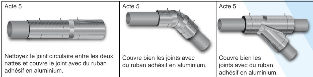
\* Les coquilles des segments isolants (pour coudes et branchements) doivent être réalisées avec un chevauchement minimale de 2 cm.
