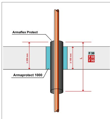
Baustoffen wie z. B. Beton, Zementmörtel etc. verschlossen. Wenn keine Isolierung über der Decke erforderlich oder möglich ist, kann ArmaFlex Protect auch unter der Decke installiert werden. Auf diesen
