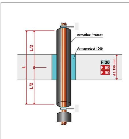
ArmaFlex Protect kann auch in Deckendurchbrüchen zentriert montiert werden. Der verbleibende Spalt in der Durchführung oder der Kernbohrung wird mit ArmaProtect 1000 oder nichtbrennbaren, formbeständigen
