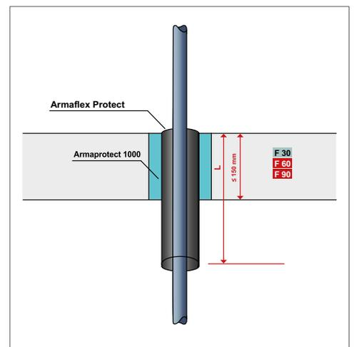
Weg können beispielsweise Heizkörperanbindungen einfach und sicher verschlossen werden. Montage bei nichtbrennbaren Rohren. Montage bei Kunststoffrohren.
