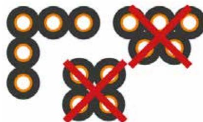
Der größte Vorteil: Metallische Rohre bis Rohraußendurchmesser von bis zu 88,9 mm und Kunststoffrohre bis Rohraußendurchmesser von bis zu 75 mm dürfen zueinander im Null-Abstand installiert werden.
