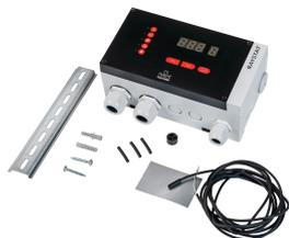
nVent RAYCHEM RAYSTAT V5 ist ein elektronischer Leitungsmessungs- oder proportionaler Umgebungssensorregler (PASC) für selbstregulierendes Heizband. Kann im Freien an die Wand montiert werden, misst die Umgebungstemperatur und bestimmt die Zykluszeit, in der die Heizkabel mit Strom versorgt werden, was zu erheblichen Energieeinsparungen führt.
