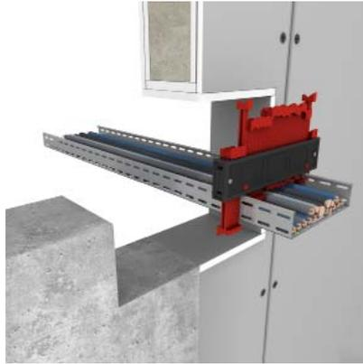
Pour reporter les contours des câbles électriques et des supports de câbles, il est recommandé d'utiliser un gabarit de contour.
