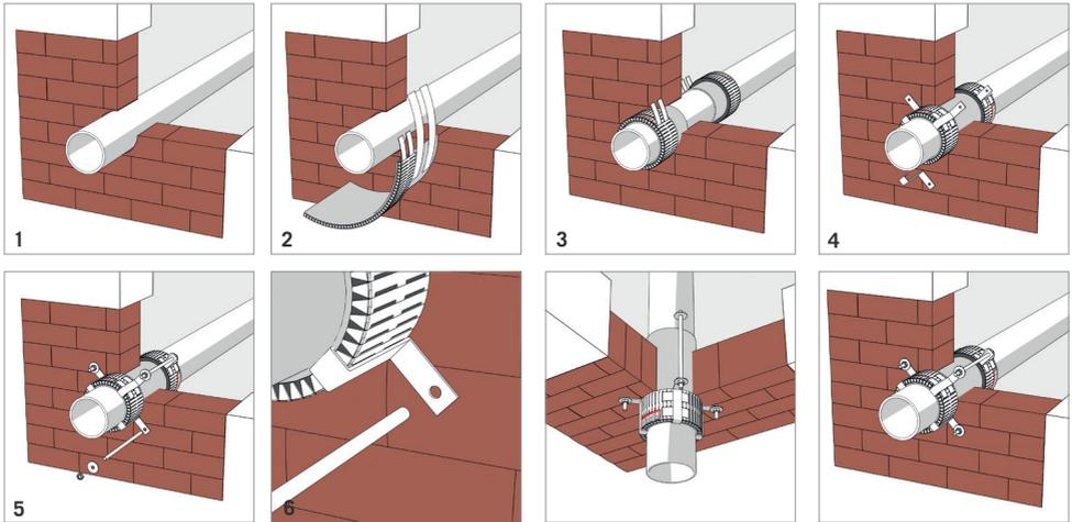
Bild 7: Deckenabschottung
