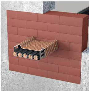
**Bild 6:** ZZ-Kabelwickel BDS-N um die Installationen
