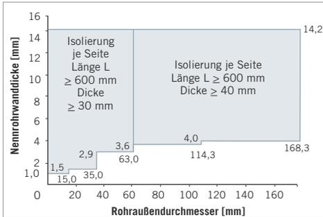
Diagramm 3: Rohre aus Stahl, Edelstahl oder Stahlguss
