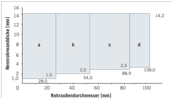
Diagramm 5: Nichtbrennbare Rohre mit einer Isolierung aus Foamglas
