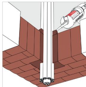
**Bild 14:** Aufbringung einer Wulst deckenoberseitig
