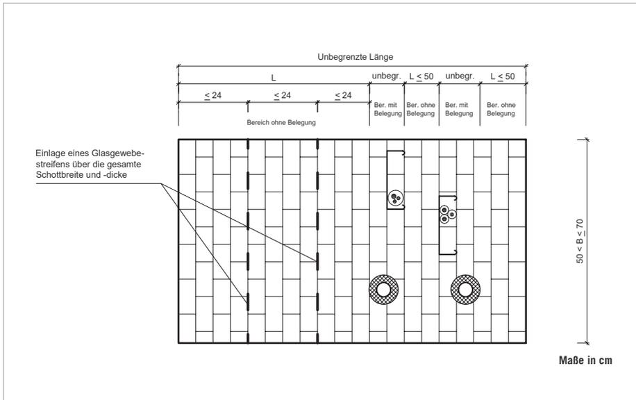
Bild 12: Einlage von Glasgewebestreifen in Decken
