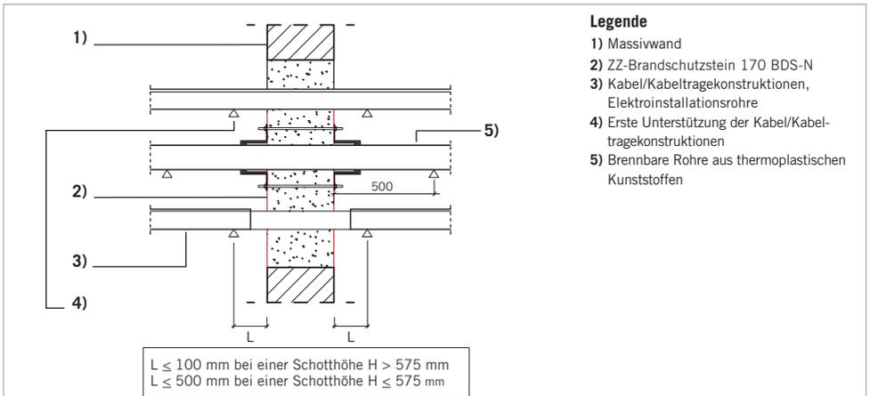
**Bild 1:** Erste Unterstützung von Kabeln / Kabeltragekonstruktionen in Wänden
