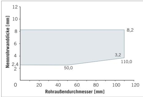
Diagramm 1: Rohre aus PVC-U, PVC-HI, PVC-C, PP
