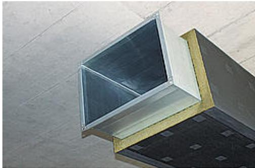
Einlagige Brandschutzbekleidung EI 90 für Lüftungskanäle aus verzinktem Stahlblech. Geprüft nach der neusten Prüfnorm EN 1366-1:2014 inklusive Einbau durch leichte Trennwände.
