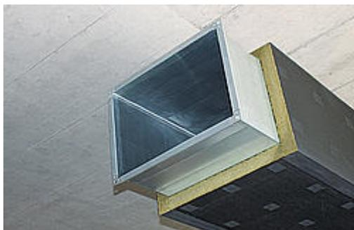
Revêtement anti-feu monocouche EI 90 pour conduits de ventilation en acier galvanisé. Certifié selon la norme la plus récente EN 1366-1:2014, y compris montage traversant pour parois de séparation légères.
