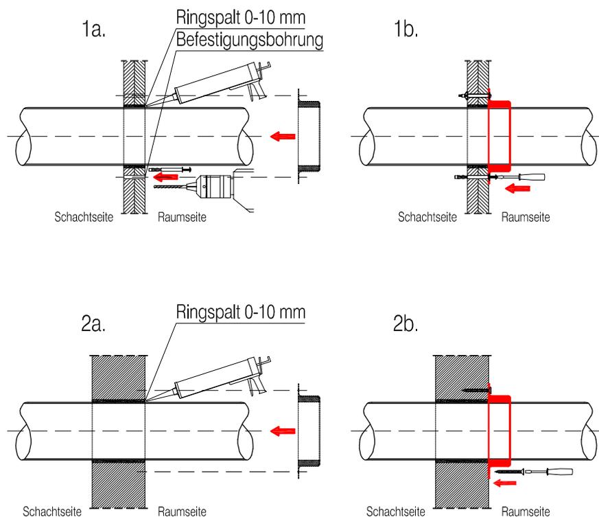
1a. Befestigungsbohrungen herstellen, Hohlraumdübel einsetzen und verankern.
