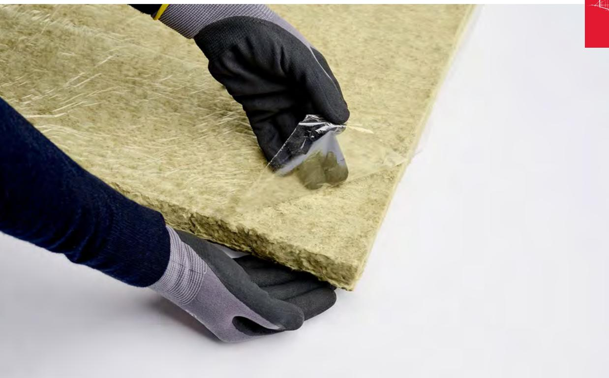
Die ROCKWOOL 133 EF ist einseitig mit einer Aluminiumfolie kaschiert und auf der Wollseite mit einer selbstklebenden Beschichtung ausgerüstet. Sie kann direkt mit dem zu dämmenden Bauteil verklebt werden. Die Klebeschicht ist mit einer abziehbaren PE-Folie abgedeckt.
