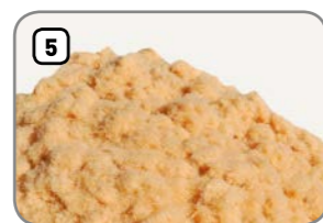
5 GUTEX Thermofibre® Fibre de bois d'isolation soufflée pour remplir des cavités fermées
