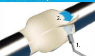
Protéger la bande DENSO® à base de pétrolatum, avec une couche de DEPROTEC®-DRM PP sur l'ensemble de la surface enrobée. Fixer le feutre antiroches dans la zone de recouvrement à l'aide d'un chalumeau, presser immédiatement le feutre pour le thermocoller. Pour obtenir une protection méca. supplémentaire, la bande à base de fibre de verre DEPROTEC®-PUR peut être utilisée.
