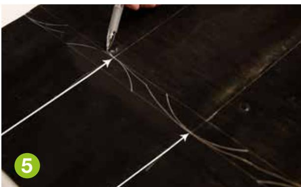
Die Längen a und b aus dem vorigen Bild verwenden, um die Größe und Form des gewünschten Teilstücks zu erstellen und das Teilstück ausschneiden.
