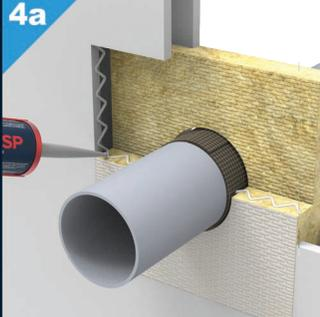
Dichten Sie den verbleibenden Spalt mit Multimastic SP oder mit dem Multimastic C System oder Multimortar System ab.
