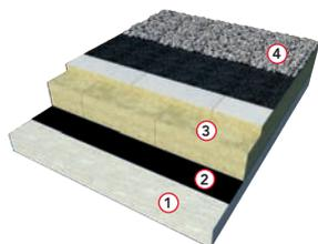
1. Support en béton, épaisseur 200 mm /  $R = 0,080 \text{ m}^2\cdot\text{K}/\text{W}$
