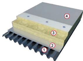
1. Support en tôles profilées métalliques, épaisseur 0,75 mm /  $R = 0,000 \text{ m}^2\cdot\text{K}/\text{W}$
