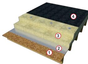
1. Support de toiture en panneaux multiplex, épaisseur 22 mm /  $R = 0,129 \text{ m}^2\cdot\text{K}/\text{W}$
