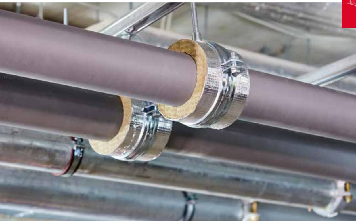
Der ROCKWOOL Rohrabhänger TECLIT Hanger besteht aus einem robusten, hochdichten Steinwollekern und einer außenliegenden Befestigungsschelle. Der Steinwollekern sorgt für eine kältebrückenfreie Abhängung bei optimaler Lastverteilung. Zum diffusionsdichten Anschluss an die Rohrdämmung ist sie mit einer sehr robusten glasfaserverstärkten Aluminiumfolie kaschiert und mit einem selbstklebenden Überlappungsstreifen ausgestattet.
