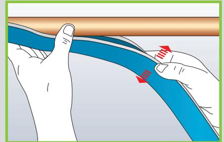
Armaflex Ultima so auf der Rohrleitung positionieren, dass die geschlitzte Fläche zugänglich ist.
