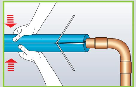
Klebenaht sorgfältig von innen nach außen zusammenfügen und mit ausreichendem Anpressdruck an jeder Stelle der Naht zusammendrücken.
