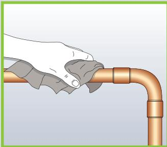
Die Rohrleitungen zunächst mit Armaflex Spezialreiniger von Staub, Schmutz, Öl und Wasser befreien. Die selbstklebenden Schläuche bei Umgebungstemperaturen zwischen +10 und +35 °C verarbeiten.
