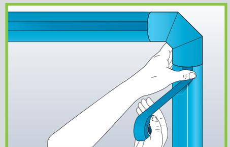
Für höhere Sicherheit ist es notwendig, die Längsstöße der selbstklebenden Armaflex Ultima Schläuche zusätzlich mit Armaflex Ultima Klebeband zu schützen. Hierbei muss die Oberfläche sauber, trocken und frei von Verunreinigungen sein. Wenn nötig vorher mit Armaflex Reiniger säubern.
