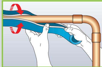
Geschlitzte Armaflex Ultima Schläuche über die Rohrleitungen stülpen. Die Abdeckfolie der Selbstklebebeschichtung im Vorfeld nicht entfernen.
