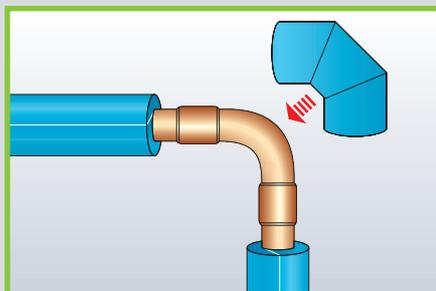
Alle anderen geraden Rohrabschnitte wie oben beschrieben dämmen. Zuletzt alle Bögen, T-Stücke usw. dämmen (siehe „Segmentbogen mit einem Mittelteil aus Armaflex Schläuchen“ in der Armaflex Montageanleitung).
