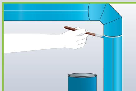
Alle Stöße mit Armaflex Kleber verschließen. Beim Verkleben von Stößen niemals „auf Zug“ arbeiten. Bei Verklebung der Stoßnähte auf Druck kann die Nassverklebung angewandt werden.
