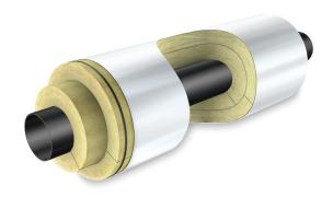
Effektiv, nachhaltig sowie eine Montage ohne großen Zeitaufwand: Das PAROC Multilayer-System ist auf solche Bedingungen abgestimmt; eine Steinwolle, die in Kombination Dämmdicken bis 300 mm realisieren kann. Die Schalenkombinationen werden nach Vorgabe der vor Ort befindlichen Bedingungen (Rohrleitungsgrößen/Dämmdicken) vorkonfektioniert, so dass eine passende und damit zeiteffektive Montage erfolgen kann.
