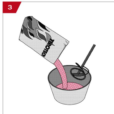
Gesamten Sackinhalt TIROTECH®-Brandschutzmörtel beifügen und mit Rührwerk (min. Ø 12 cm) anrühren, ca. 1 Minute.
