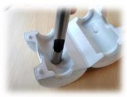
Mit der Lochpfeife oder mit angespitztem Rohrstück lassen sich (bei Bedarf) auch die Löcher für die Rohraustritte sowie den Spindelhals vergrößern.
