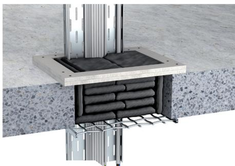
Bei einer Bauteildicke < 250 mm muss das Bauteil mittels nichtbrennbaren Bauplatten auf die erforderliche Mindestdicke von 250 mm aufgedoppelt werden. Zur Fixierung der Brandschutzkissen in der Bauteilöffnung dient ein deckenunterseitig angebrachtes Stahlgitter.
