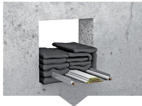
Die weiteren Lagen der Brandschutzkissen so dicht wie möglich um die Kabel verlegen. Darauf achten, dass zur optimalen Ausnutzung der Öffnung verschiedene Kissengrößen verwendet werden.
