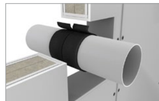
Enveloppez des deux côtés du tuyau combustible à fleur avec la surface de l'obturateur
