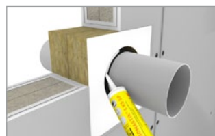
Obturez la fente annulaire avec HENSOMASTIK® 5 KS SP
