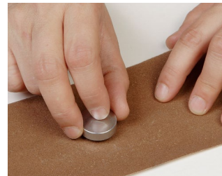
Haftmagnet und Kontakttring können anstatt ausgetauscht oft auch gereinigt werden. Dazu einige Male mit der verschmutzten Seite über feines Schleifpapier bewegen.
