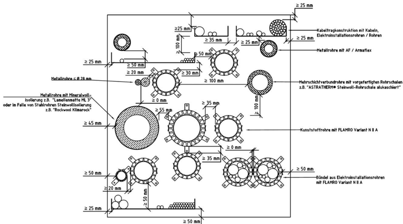
Horizontale und vertikale Abstände / Mindestarbeitsfreiräume – betreffend durchgeführte Elemente –, die in der Einbauzeichnung nicht angeführt sind, müssen in der Praxis  $\geq 100\text{ mm}$  betragen.
