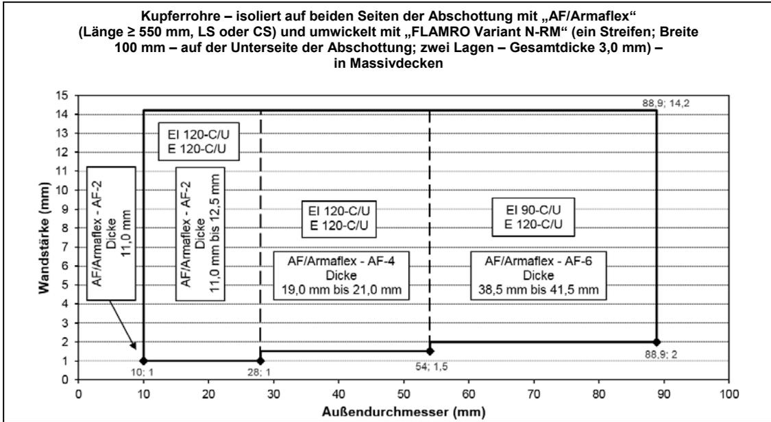
Anmerkung: Die angeführten Diagramme und die darin enthaltenen Feuerwiderstandsklassen gemäß EN 13501-2:2007+A1:2009 gelten nur für Metallrohre gemäß Punkt 2.1 der ETA.
