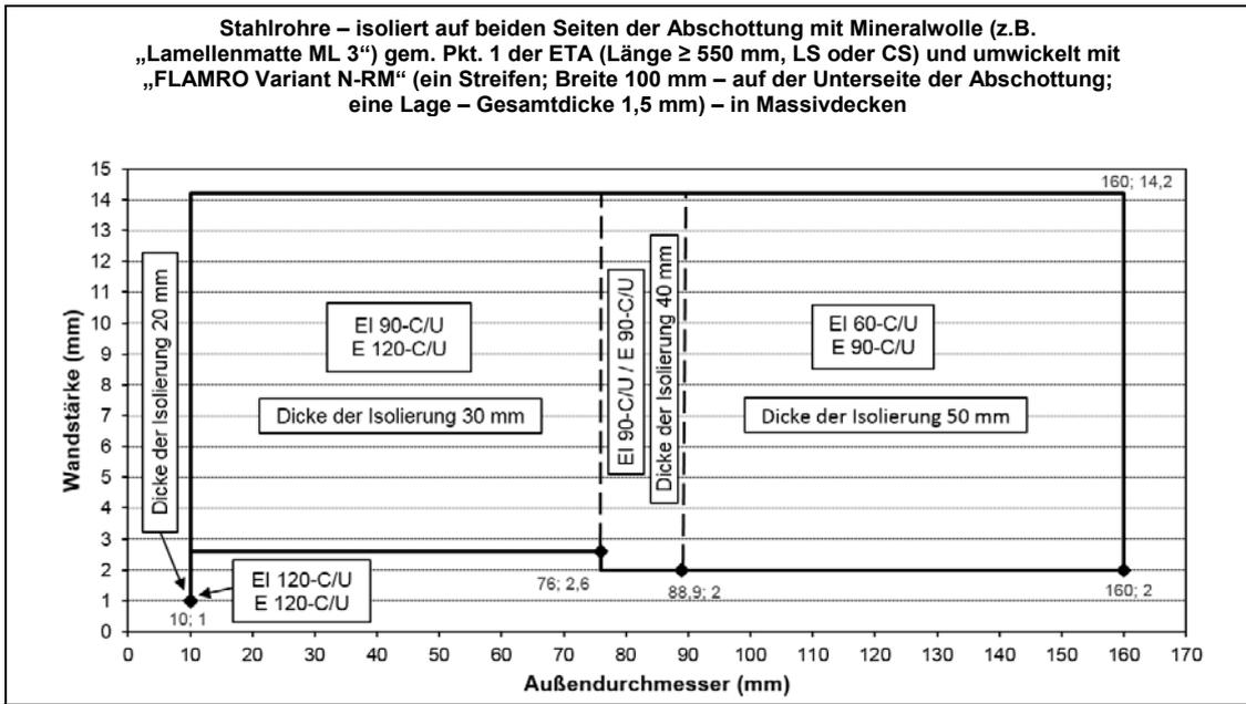
Anmerkung: Die angeführten Diagramme und die darin enthaltenen Feuerwiderstandsklassen gemäß EN 13501-2:2007+A1:2009 gelten nur für Metallrohre gemäß Punkt 2.1 der ETA.
