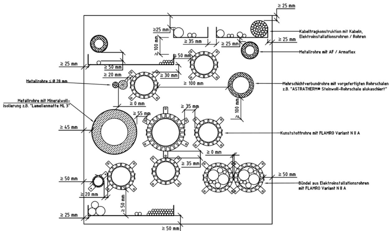
Horizontale und vertikale Abstände / Mindestarbeitsfreiräume – betreffend durchgeführte Elemente –, die in der Einbauzeichnung nicht angeführt sind, müssen in der Praxis  $\geq 100 \text{ mm}$  betragen.
