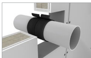
Beidseitige Wicklung* um das brennbare Rohr, bündig zur Schottoberfläche
