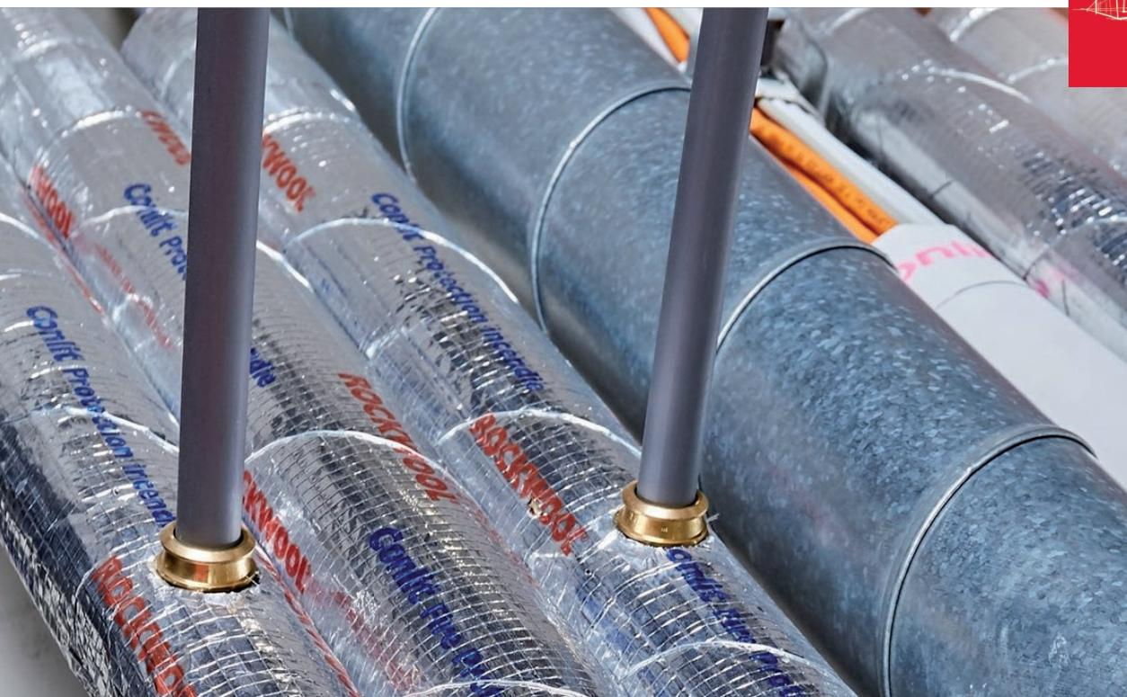
Die Conlit 150 U ist eine nichtbrennbare kunstharzgebundene druckfeste Steinwolle-Brandschutzschale für den Einsatz in Rohrabschottungen. Sie ist mit einer farbigen gekennzeichneten gitternetzverstärkten Aluminium-Sandwich-Folie kaschiert. Die Conlit 150 U ist einseitig aufgeschlitzt und auf der Innenwandung eingesägt, damit sie leicht aufgeklappt und auf der Rohrleitung montiert werden kann.
