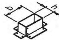
Ein- und Ausführung FLAMRO BSK: b \times h entsprechend Kanalgröße, FLAMRO BSK A: b \times h \leq 350 \times \leq 100
