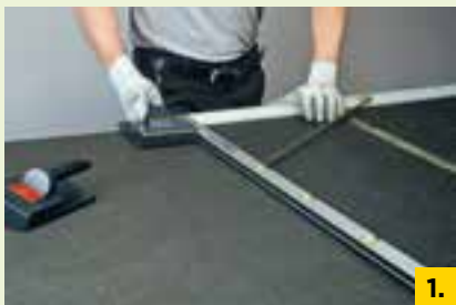
1. Stufenfalz mit CLIMAVER® Werkzeugen herstellen
