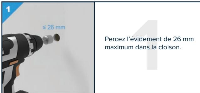
Percez l'évidement de 26 mm maximum dans la cloison.
