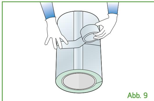
Zum Zuschneiden der Bänder auf die erforderliche Länge eine Schere/ein Messer benutzen und dabei vermeiden, das Band zu ziehen und abzureißen. Sobald das Band verlegt ist, gleichmäßigen Druck auf die ganze Länge des Bandes ausüben, damit es richtig haftet. Auch an den Querfugen zwischen aneinander stoßenden Abschnitten des Isoliermaterials Streifen und Bänder anbringen (**Abb. 9**).
