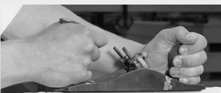
Plaatkant schaven met surformschaaf
