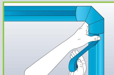
Isoler toutes les autres sections droites des tuyaux en suivant la procédure décrite ci-avant. Pour terminer, isoler les coudes, les jonctions en T, etc. (cf "Coude segmenté avec un élément central en manchon Armaflex").
