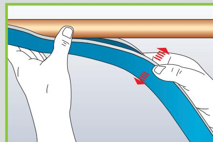
Éliminer la poussière, la saleté, l'huile et l'eau présentes au niveau des tuyauteries. Si nécessaire, utiliser le nettoyant Armaflex. Installer les produits Armaflex à une température ambiante située entre +10 et +35 °C.
