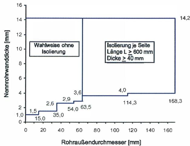
**Rohre aus Kupfer nach Anlage 1 mit Isolierungen aus Mineralfaserprodukten gemäß Abschnitt 2.1.4.1:**
