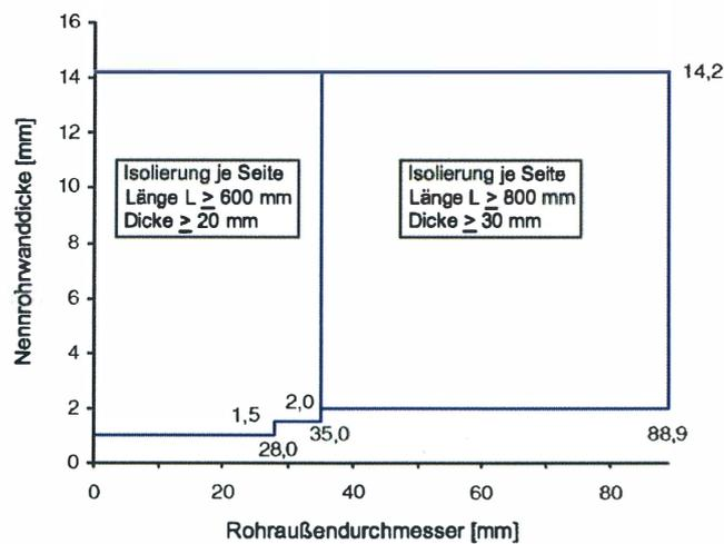
Für die Rohrisolierung müssen nichtbrennbare (Baustoffklasse DIN 4102-A) Mineralfasermatten oder Mineralfaserschalen verwendet werden, deren Schmelzpunkt über 1000 °C nach DIN 4102-17 liegen muss. Die Nennrohrdichte muss mindestens 90 kg/m³ betragen. Die Rohrisolierung und der Mantel dürfen wahlweise durch die Abschottung hindurchgeführt werden oder an der Schottoberfläche angrenzen. Die Rohrisolierungen sind mit Spannbändern oder Draht zu befestigen (mindestens 6 Wicklungen pro lfd. Meter).
