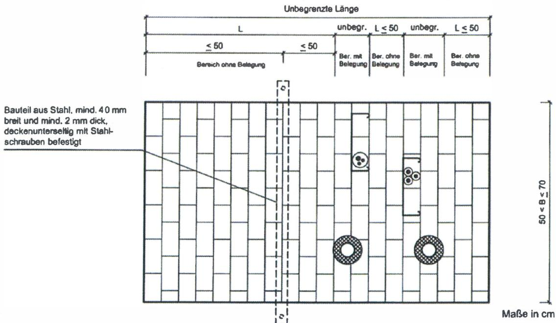
Bei Einbau in Öffnungen in Massivdecken (s. Anlagen 15 - 17), die breiter als  $50\text{ cm} < B \leq 70\text{ cm}$  sind, muss in Abschottungen ohne Belegung bzw. in Bereichen ohne Belegung mit einer Länge  $L > 50\text{ cm}$  eine der folgenden Maßnahmen erfolgen (s.a. Abschnitt 4.4.7):
