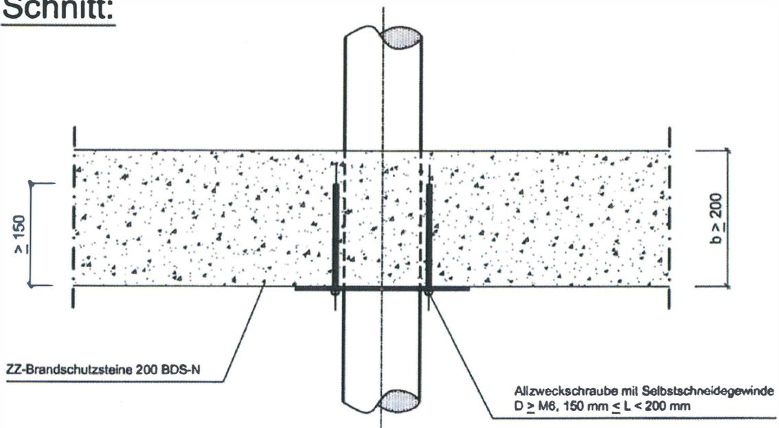
Kabelabschottung (Kombiabschottung) "Kombischott ZZ-Steine 200 BDS-N" der Feuerwiderstandsklasse S 90 nach DIN 4102-9
