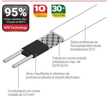
Le ruban chauffant autorégulant nVent RAYCHEM HTV est conçu pour la mise hors gel ou le maintien en température des tuyauteries et réservoirs soumis à de très hautes températures de service en continu (205 °C).
